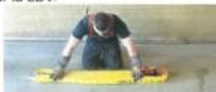
Connecter la LDV (position fermée) et refermer le tuyau. Si le demi-raccord libre est trop court, le mettre à l'intérieur du tuyau.
