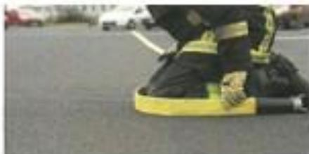
Prendre la mesure du tuyau comme pour le pliage en "Z" en plaçant le demi-raccord au niveau de la cheville
