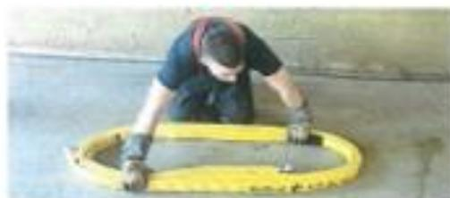
En fin de pliage, ouvrir et faire pivoter l'ensemble du tuyau pour créer un espace pour la LDV.
